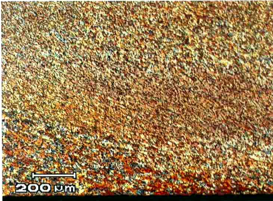
Figura 11 – Micrografia da secção transversal na região 4. Aumento:50X. Ataque: Barker.
