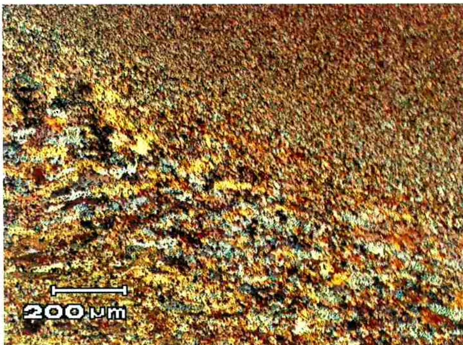
Figura 12 – Micrografia da secção transversal na região 5. Aumento: 50X. Ataque: Barker.
