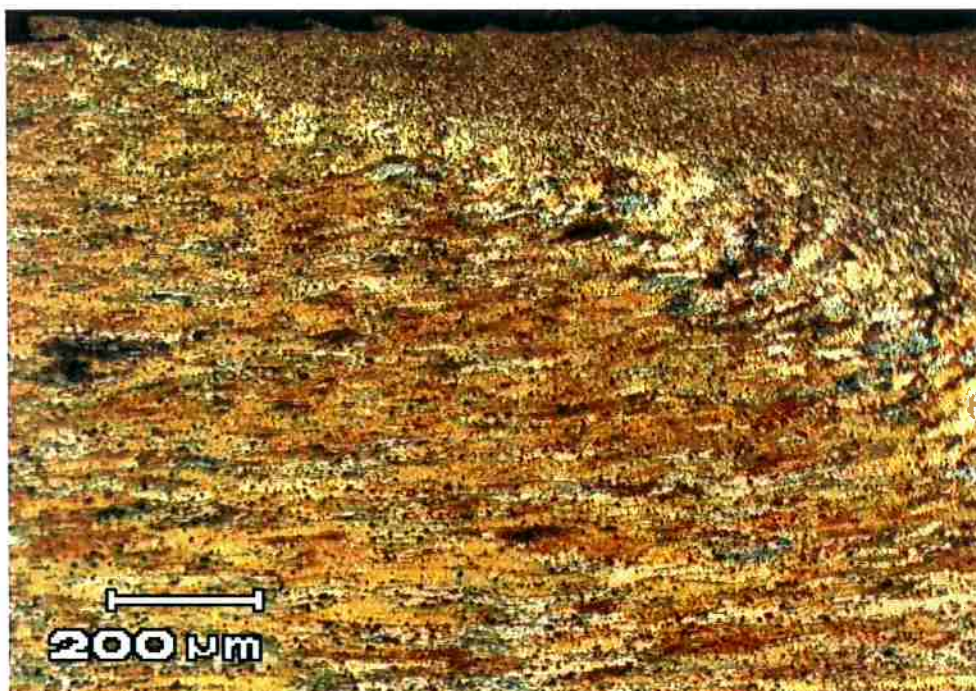
Figura 13 - Micrografia da secção transversal na região 6. Aumento: 50X. Ataque: Barker.
