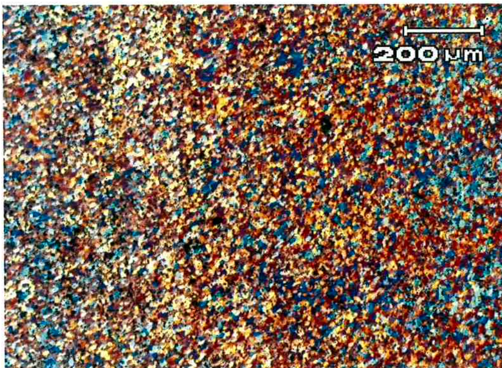
Figura 23- Micrografia da parte inferior na região 3. Aumento: 50X. Ataque: Barker.
