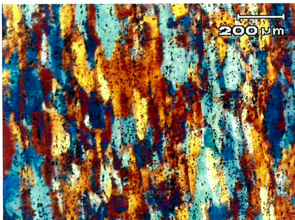
Figura 26 - Micrografia da parte inferior na região 5. Aumento: 50X. Ataque: Barker.
