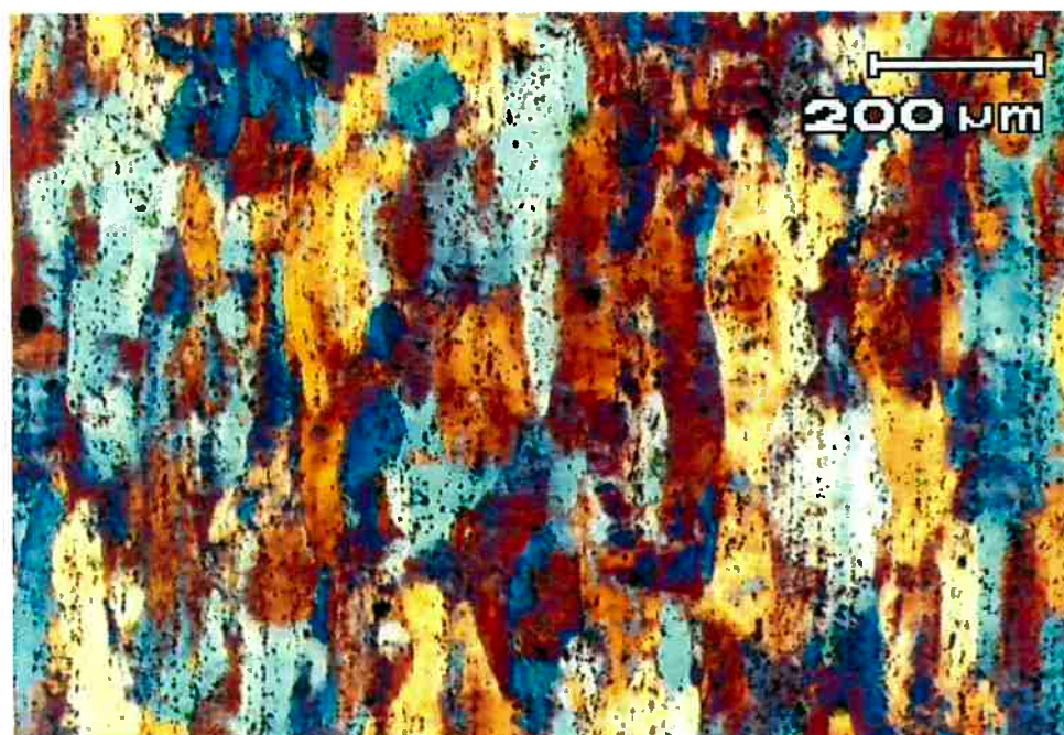
Figura 20 - Micrografia da parte superior na região 5. Aumento: 50X. Ataque: Barker.
