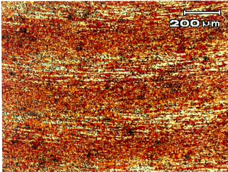
Figura 17 - Micrografia da parte superior na região 3. Aumento: 50X. Ataque: Barker.
