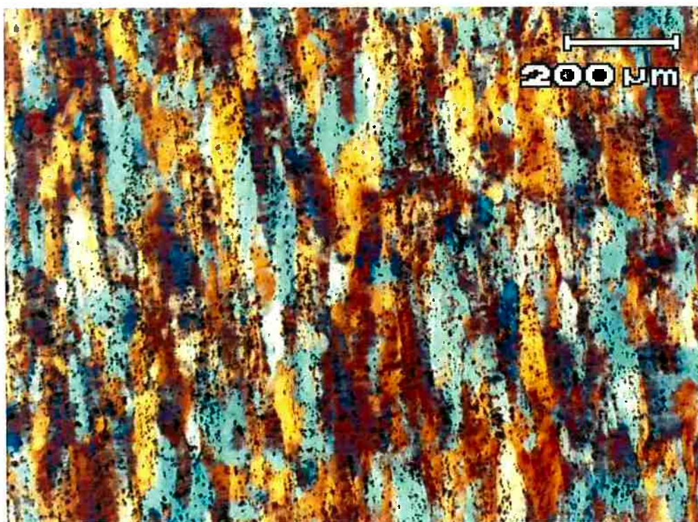
Figura 21 - Micrografia da parte inferior na região 1. Aumento: 50X. Ataque: Barker.
