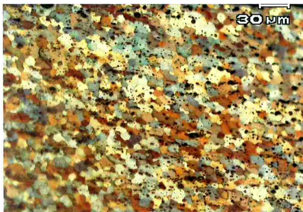
Figura 8 – Micrografia da secção transversal na região 1. Aumento: 200X. Ataque: Barker.
