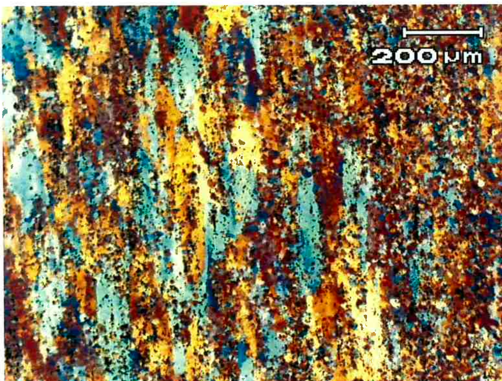
Figura 25 - Micrografia da parte inferior na região 4. Aumento: 50X. Ataque: Barker.
